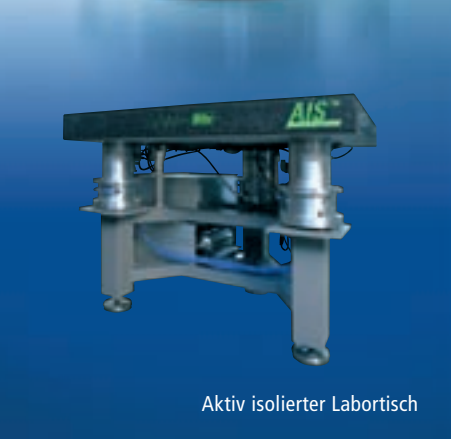
Isolierte Plattform für Elektronenmikroskop
